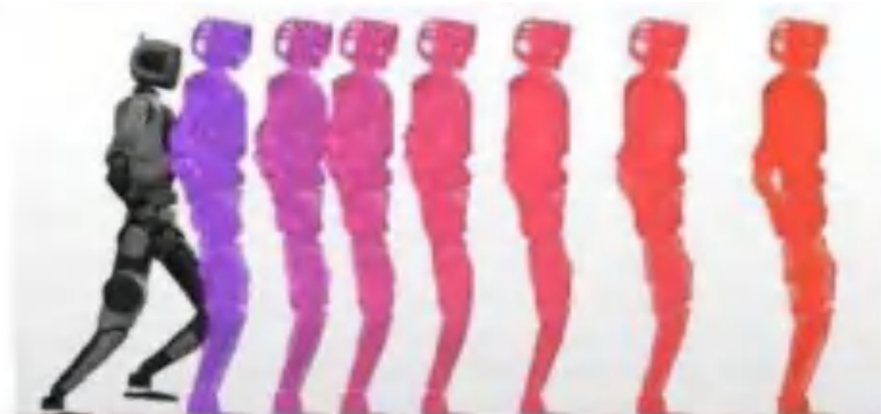
图 1.1.7：电驱版 Atlas 依托 MPC 规划未来行动轨迹 (1/2)
