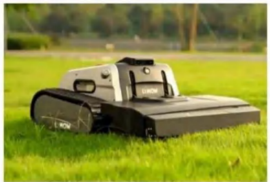
图88：履带式底盘在室外也有较好的通过性
