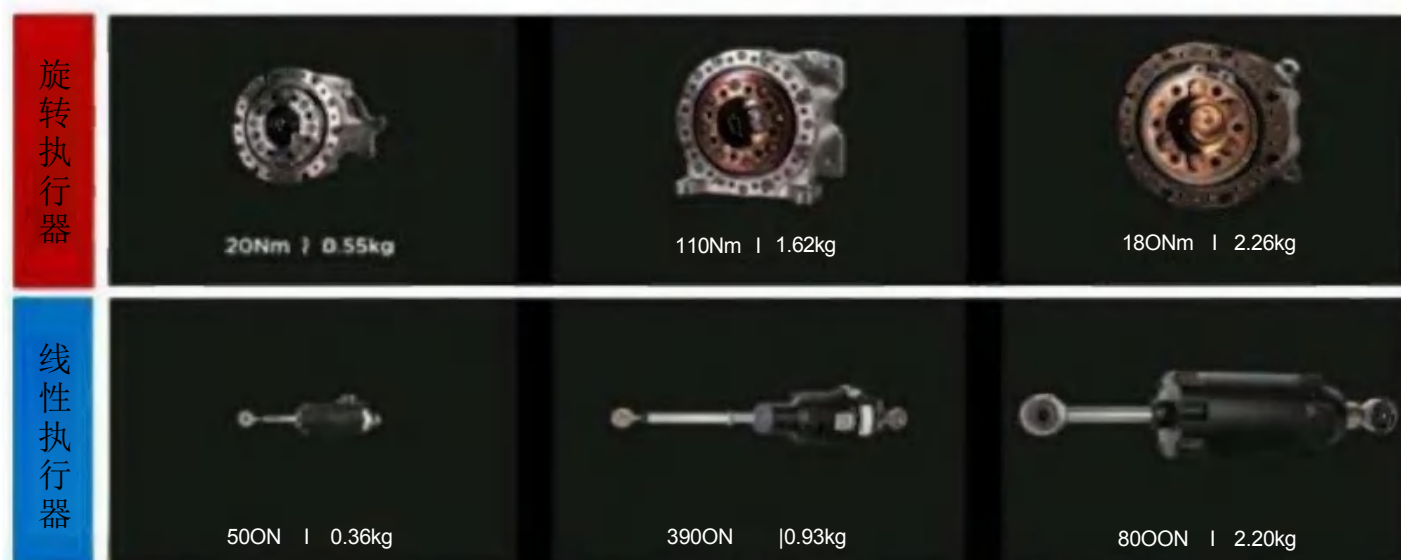
图95：特斯拉Optimus使用的执行器分为三种旋转和三种线性执行器
