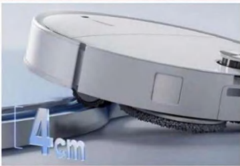
图87: 轮式底盘能通过底盘升降通过室内的低矮门槛
