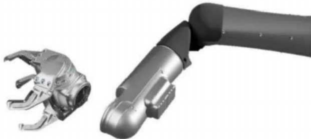
图99: Agility Digit 执行器可拆卸式结构
