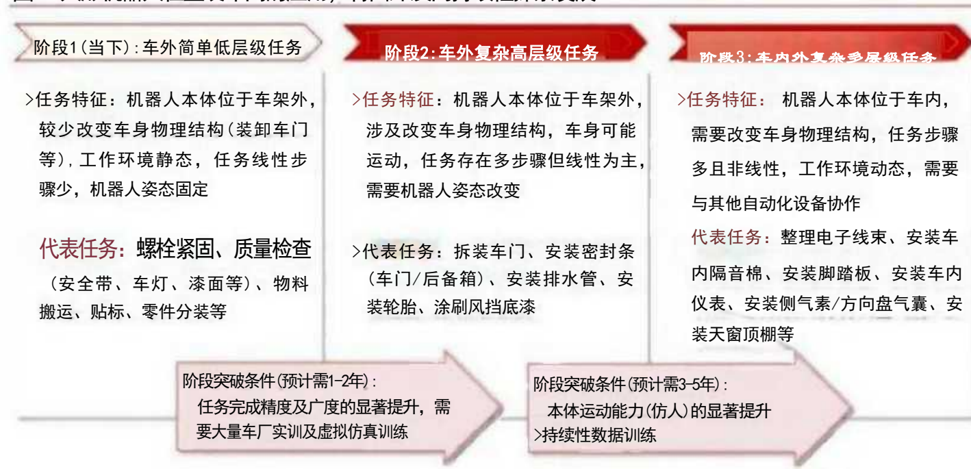
图66:人形机器人在整装车间的应用，将由外及内持续性探索发展
